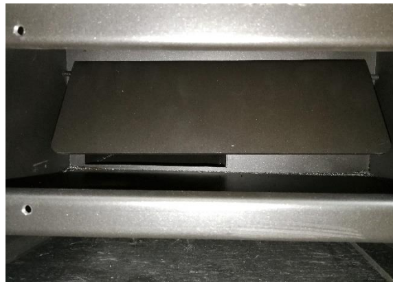
Foto 2: confirmar que el deflector está correctamente sujeto con los ganchos. Como se muestra en la foto.
