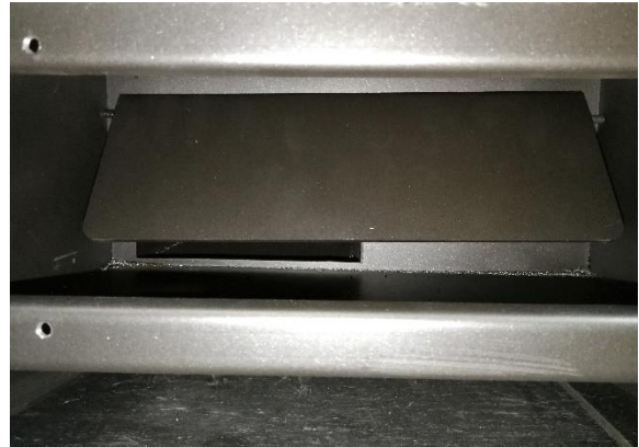
Bild 2: Überprüfen Sie die korrekte Position der Rauchleitplatte.
