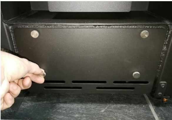
Immagine 1: rimuovere le viti e la piastra di copertura per individuare il deflettore.
