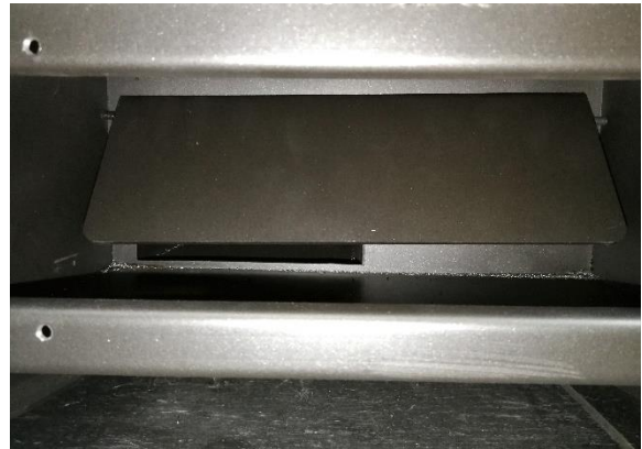
Bild 2: Überprüfen Sie die korrekte Position der Rauchleitplatte.
