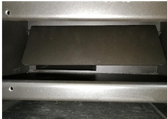
Afbeelding 2: controleer of de rookgeleiderplaat correct is geplaatst.
