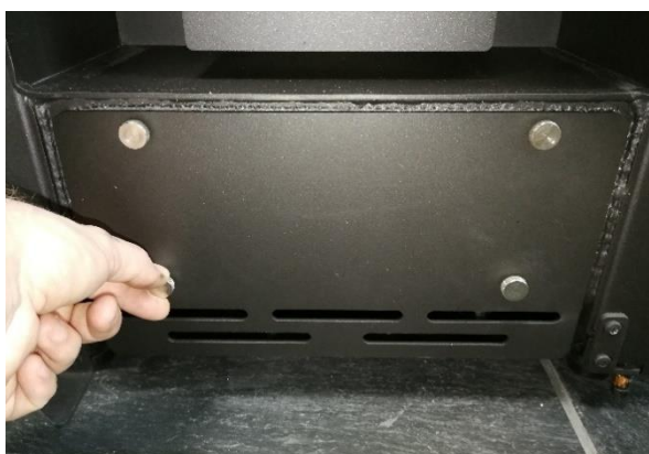
Bild 1: Skruva bort de fyra skruvarna och ta bort skivan för att hitta rökledarskivan.
