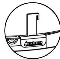
Telkens wanneer u nieuw hout in de kachel legt moet voor het aansteken de Aduro-Tronic worden geactiveerd. Alleen op deze manier kan optimale verbranding worden gegarandeerd. U activeert de Aduro-Tronic door de primaire schuif uit te trekken zodra u nieuw brandhout hebt aangevuld. De Aduro-Tronic sluit de primaire lucht vervolgens op basis van de ingestelde sluittijd (ong. 6 minuten). Meer informatie over de luchtregeleiding van Aduro-Tronic vindt u in de complete gebruiksaanwijzing.
