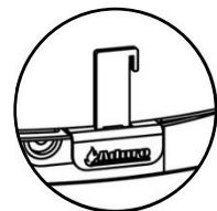
Immer wenn neues Holz nachgelegt wird, muss zum Anfeuern die Aduro-tronic aktiviert werden. Nur dann kann eine optimale Verbrennung sichergestellt werden. Sie aktivieren die Aduro-tronic durch Herausziehen des Primärschiebers, sobald Sie neues Brennholz nachlegen. Die Aduro-tronic schließt danach die Primärluft gemäß der voreingestellten Schließzeit (ca. 6 Minuten). Erfahren Sie mehr über die Aduro-tronic und deren Regulierung in der vollständigen Bedienungsanleitung.
