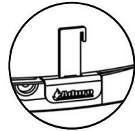
Varje gång du lägger på ny ved i braskaminen måste du tillföra primärluft i lagom mängd under de första minuterna. Du aktiverar automatiken genom att dra ut primärspjället varje gång du lägger in ny ved. Aduro-tronic-autamatiken stänger sedan spjället gradvis efter förprogrammerad tid (ca 6 minuter). Läs mer om Aduro-tronic och hur den regleras i den fullständiga bruksanvisningen.
