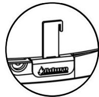
Hver gang, der lægges nyt træ ind i brændeovnen, skal der tilføres primærluft i en nøje afmålt mængde de første minutter. Du aktiverer automatikken ved at trække primærspjældet ud, hver gang der lægges brænde ind. Aduro-tronic automatikken vil derefter lukke spjældet gradvist efter den forprogrammerede tid (ca. 6 minutter). Læs mere om Aduro-tronic og dens regulering i den fulde betjeningsvejledning.
