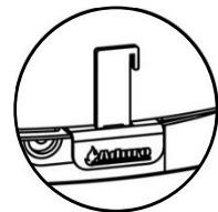
Ad ogni immissione di nuova legna nella stufa, per i primi minuti verrà immessa una precisa quantità di aria primaria. Attivare l'automatismo estraendo la leva primaria ogni volta che si introduce legna fresca nella stufa. Il dispositivo automatico chiuderà lentamente l'alimentazione dell'aria entro circa 6 minuti. Maggiori informazioni su Aduro-tronic e la sua regolazione nel manuale dell'utente.
